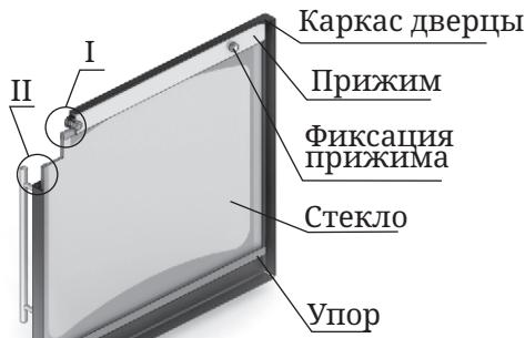
Рисунок 18. Ремонт светорозрачного экрана дверцы модификации «Витра»
