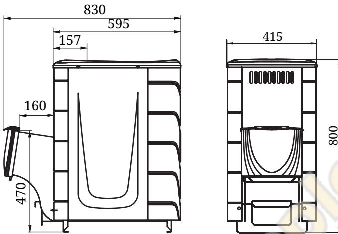
Рисунок 2. Габаритные размеры печи «Тунгуска 2011»
