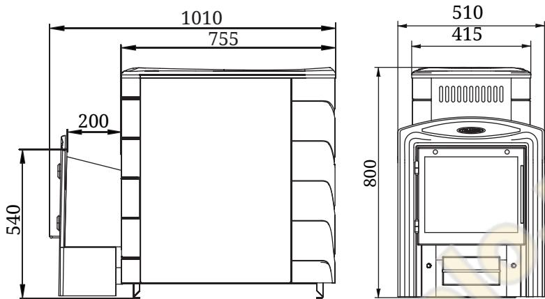
Рисунок 3. Габаритные размеры печи
