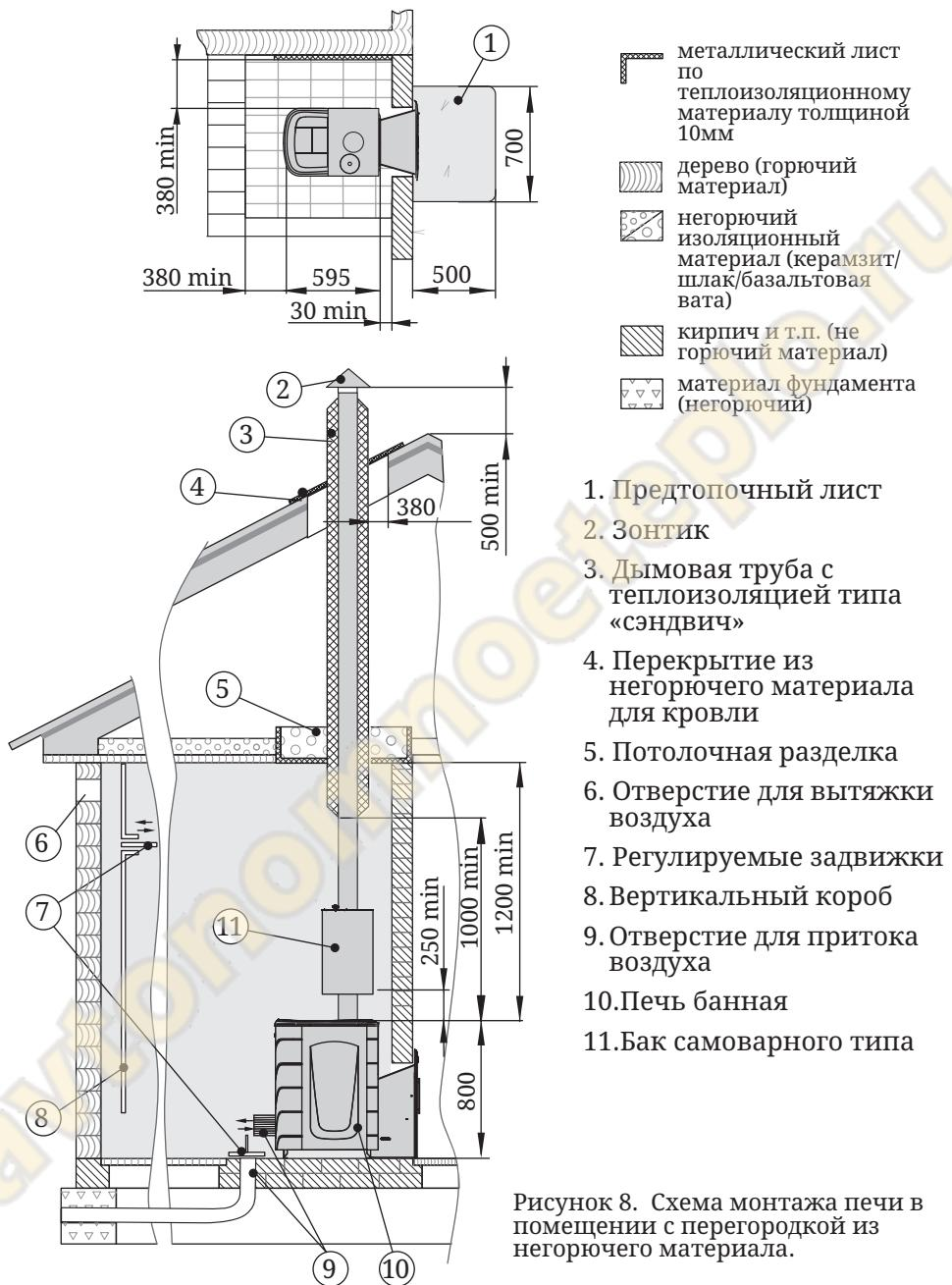
Рисунок 8. Схема монтажа печи в помещении с перегородкой из негорючего материала.
