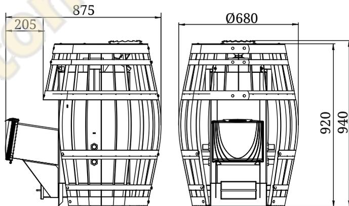
**Рисунок 5. Габаритно-монтажные размеры печи «Саяны XXL 2015»**
