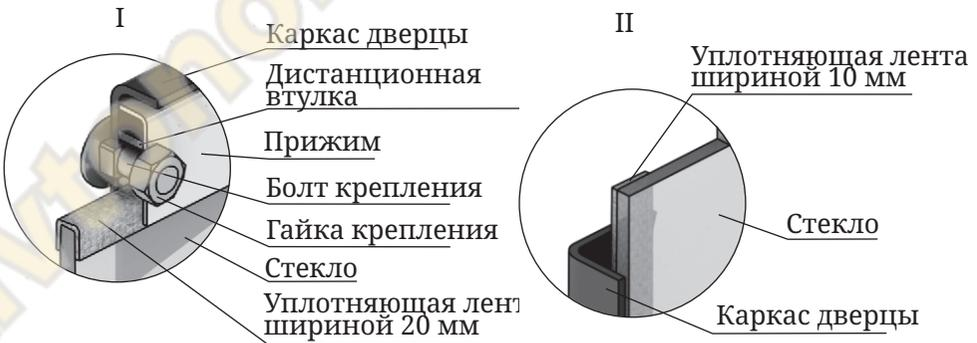
Рисунок 13. Крепление светопрозрачного экрана дверцы модели «Витра»
