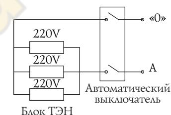
Рисунок 10. Схемы соединения блока ТЭН.
