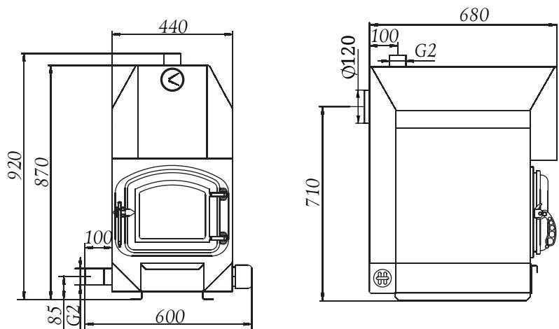
Рисунок 3. Водогрейный котел «Инженер Гидравлик» с ТЭН
