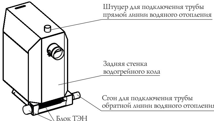
Рисунок 5. Расположение блока трубчатых электро нагревателей (ТЭН).
