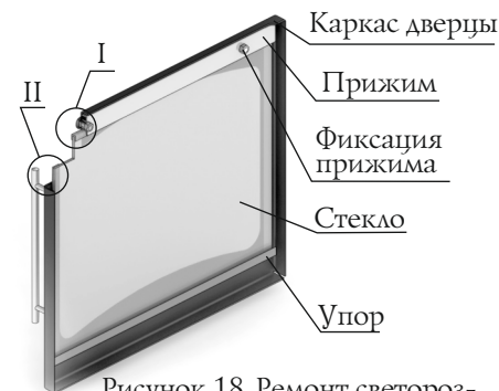
Рисунок 18. Ремонт светопрозрачного экрана двери модели «Витра»
