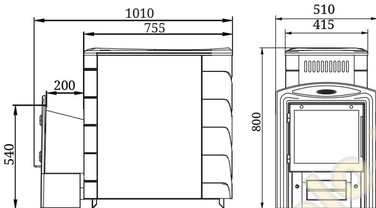
Рисунок 3. Габаритные размеры печи
