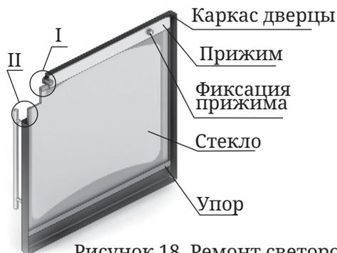
Рисунок 18. Ремонт светорозрачного экрана дверцы модификации «Витра»
