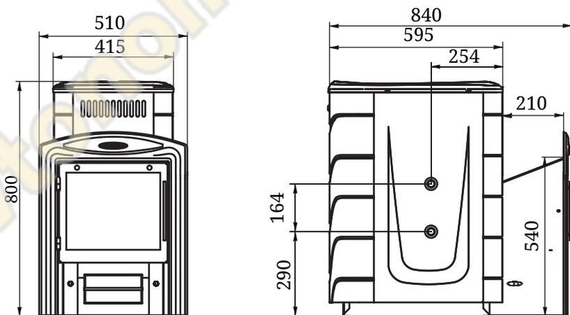
**Рисунок 1. Габаритные размеры печи «Тунгуска 2011 Витра»**
