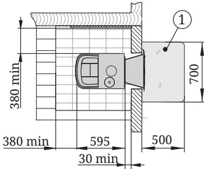
1. металлический лист по теплоизоляционному материалу толщиной 10мм
