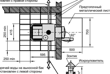
Трубопроводы горячей воды на выносной бак теплообменник установлен с левой стороны
