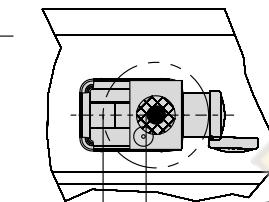
Расстояние в свету от наружной поверхности трубы до стропил обрешетки и других деталей кровли из горючих и трудногорючих материалов
