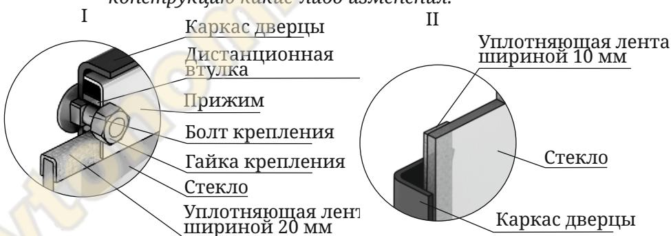
Рисунок 15. Крепление светорозрачного экрана дверцы модификации «Витра»
