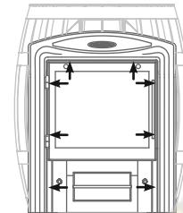
Рисунок 11. Место установки саморезов
