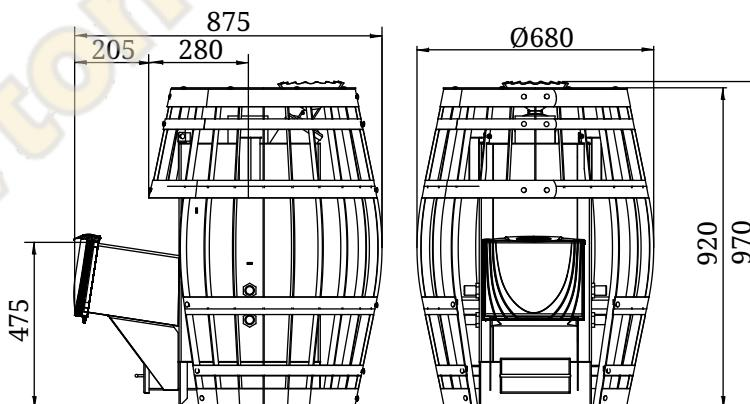
**Рисунок 5. Габаритно-монтажные размеры печи «Саяны XXL 2015»**
