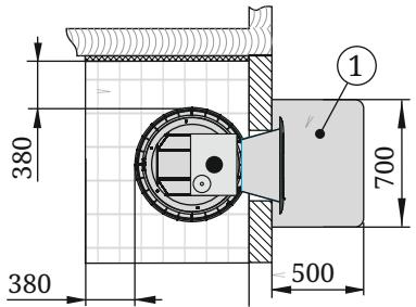
металлический лист по теплоизоляционному материалу (асбестовому картону толщиной 10мм)
