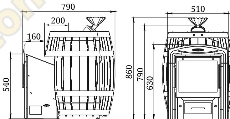
Рисунок 8. Габаритно-монтажные размеры печи «Саяны II ЗК Витра»
