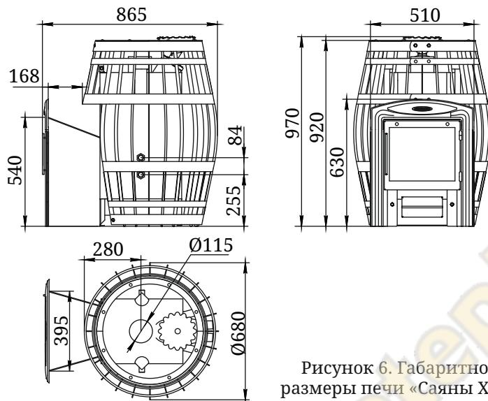
Рисунок 6. Габаритно-монтажные размеры печи «Саяны XXL 2015 Витра»
