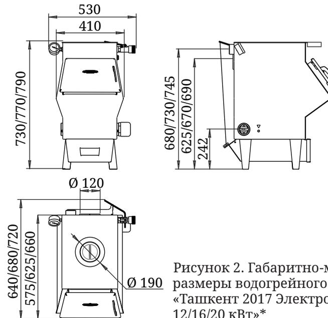
Рисунок 2. Габаритно-монтажные размеры водогрейного котла «Ташкент 2017 Электро» с ЧВК на 12/16/20 кВт»\*
