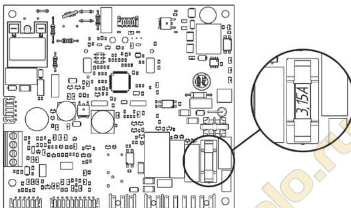
Рис. 13. Расположение предохранителя
