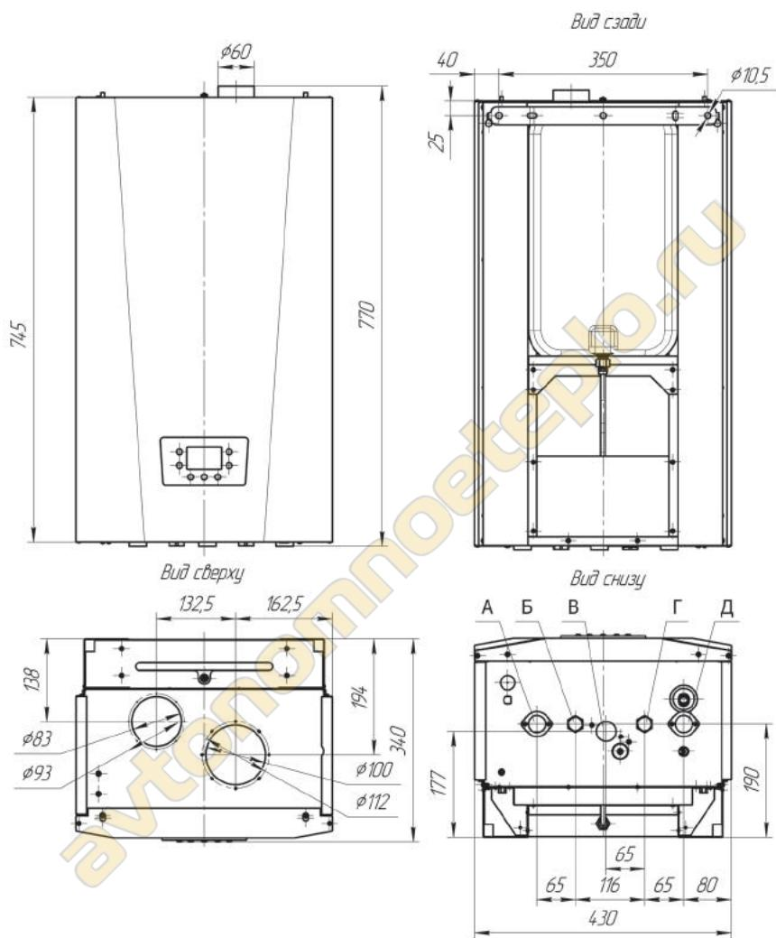
**Рис 2.2. Габаритные и присоединительные размеры котлов PRIME-V26...32**
