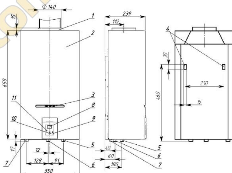
1 – патрубок газоотводящего устройства; 2 – облицовка; 3 – окно смотровое; 4 – монтажные отверстия; 5 – штуцер подвода холодной воды, резьба G 1/2; 6 – штуцер подвода газа, резьба G 1/2; 7 – штуцер отвода горячей воды, резьба G 1/2; 8 – дисплей температуры воды; 9 – кнопка уменьшения задаваемой температуры; 10 – кнопка увеличения задаваемой температуры; 11 – индикатор разряда элемента питания.
