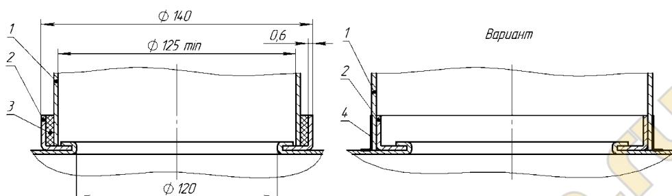
1 - газоотводящая труба; 2 – патрубок газоотводящего устройства аппарата;
