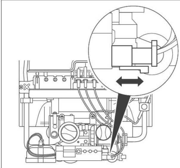
Рис. 7.1 Штекерный контакт электрода розжига, тип RXI
