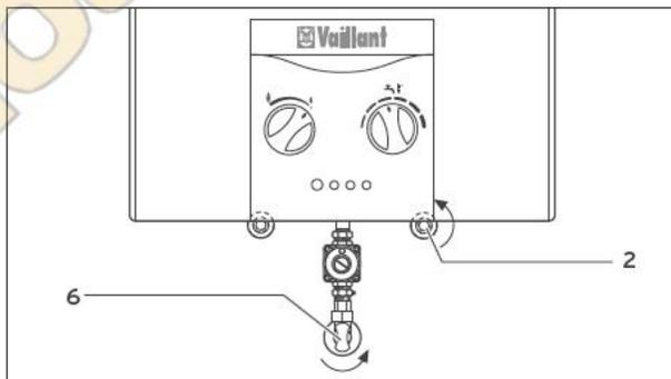
Рис. 4.3 Запорные устройства
