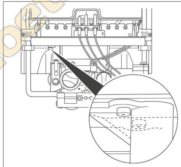
Рис. 7.4 Крепление горелки на газовой арматуре, тип GRX
