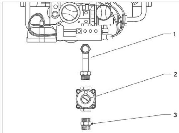
Рис. 4.1 Монтаж регулятора давления газа, тип RXi
