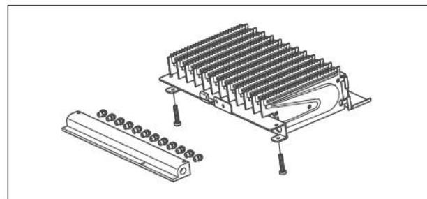
Рис. 7.3 Конструкция горелки
