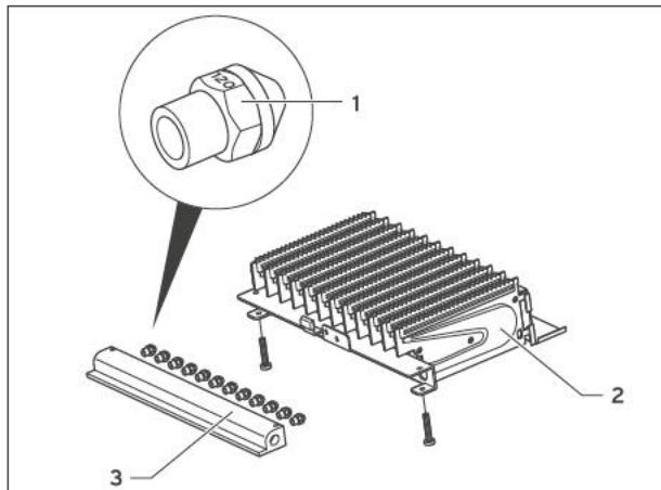
Рис. 6.6 Маркировка сопла
