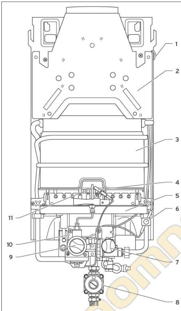
Рис. 2.1 Узлы водонагревателя атмоMAG 14.0/0 типа RXZ
