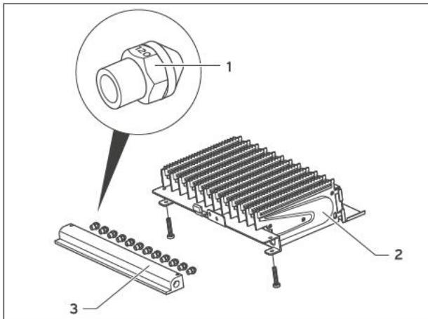
Рис. 6.3 Маркировка сопла
