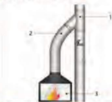
1 - дымоход 2 - гибкая труба Multinox 3 - топка
