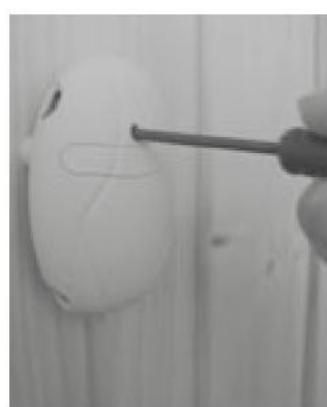
Рис. 15. Кнопка сброса защиты от перегрева.
