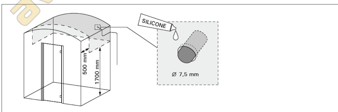
**Рисунок 8. Установка температурного датчика**
