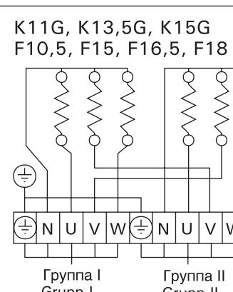
Рис. 5. Схема электроподключений каменки, установленной в качестве групповой
