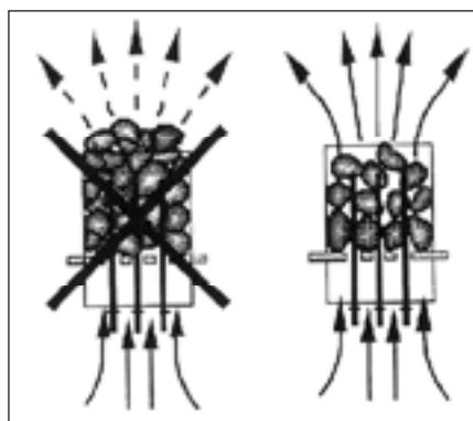
Рис. 1. Укладка камней
