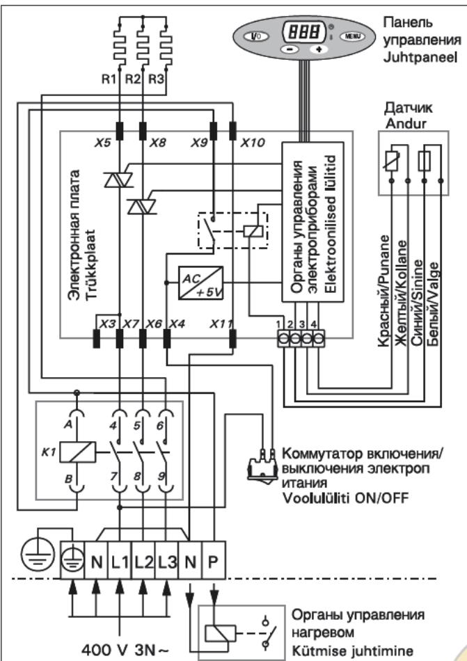
**Рисунок 11а. 3-фазное подключение каменок V45E, V60E, V80E**
