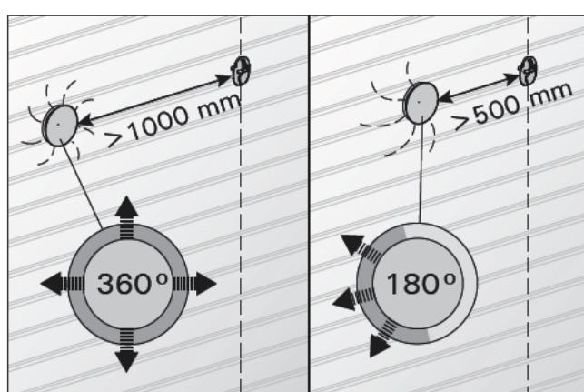
**Рисунок 6. Минимальное расстояние между датчиком и вентилятором**
