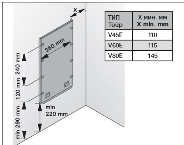
**Рисунок 8. Установка крепежной рамы**
