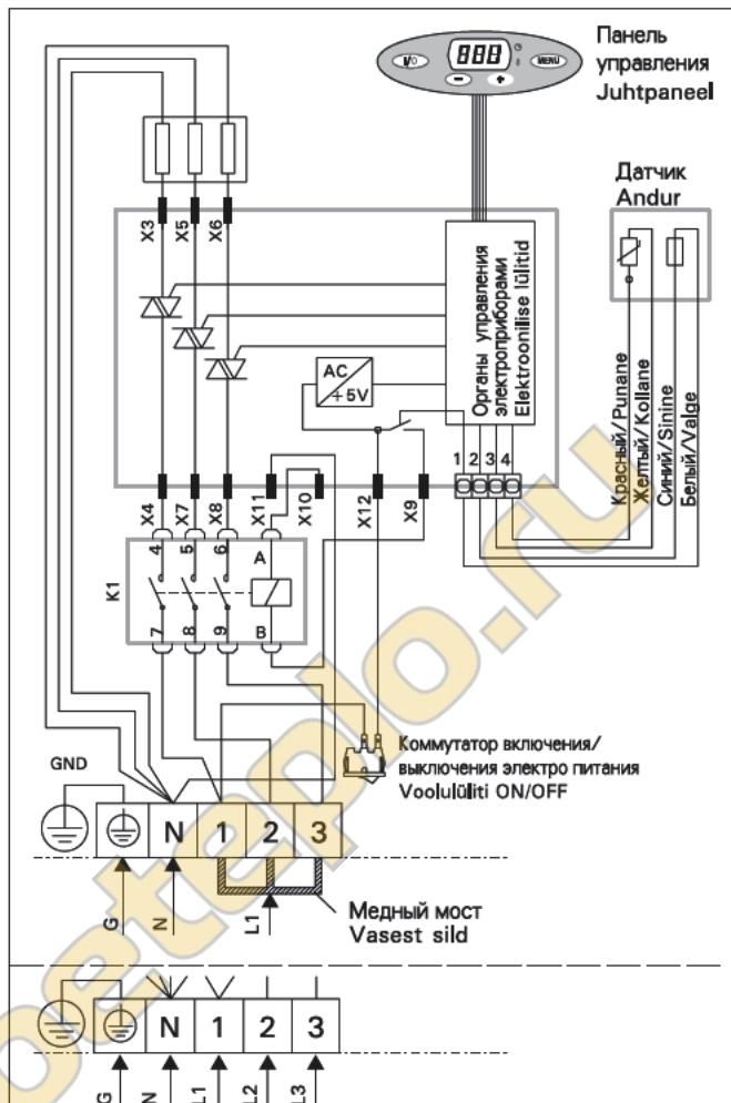
**Рисунок 11б. 1/3-фазное подключение каменок V45E-1, V60E-1, V80E-1**
