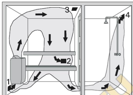
1. Värske õhu ventilatsiooniava paigaldamise piirkond
