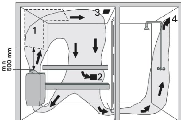
1. Область расположения приточного вентиляционного отверстия.
