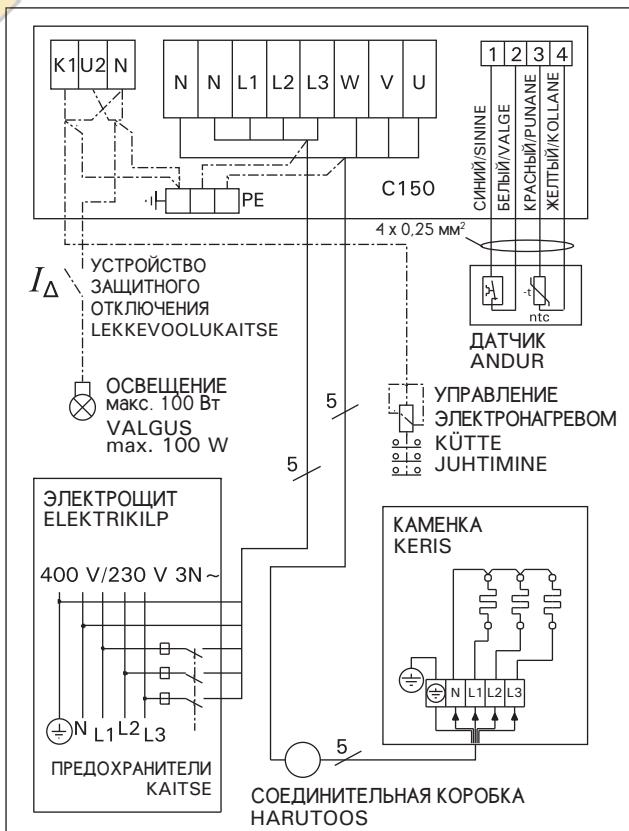
**Рисунок 18.** Электромонтаж пульта управления
