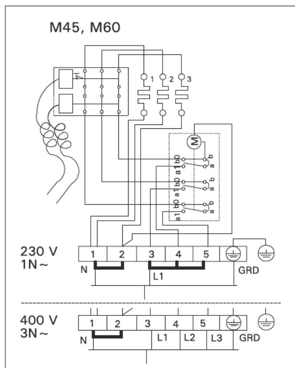
*Рисунок 13. Электромонтаж каменки M
