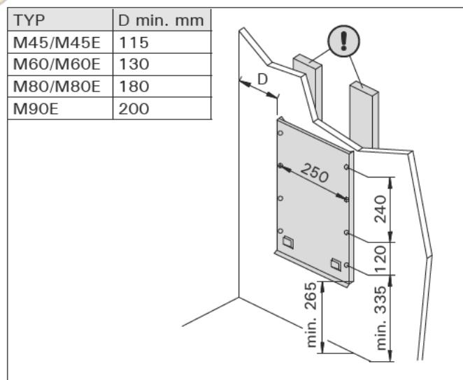
Рисунок 9. Установка монтажной рамы (все размеры приведены в миллиметрах)
