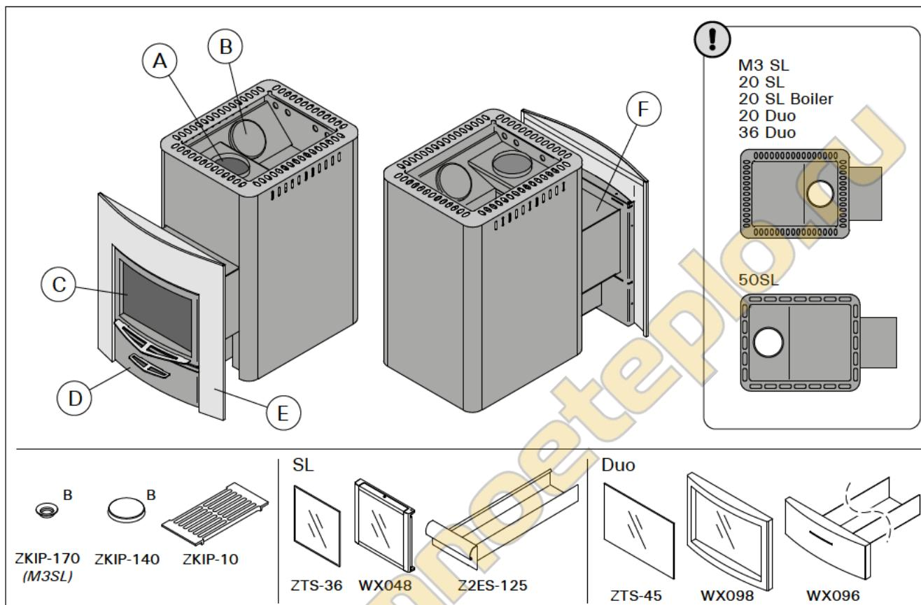
Рисунок 1. Элементы конструкции каменки
