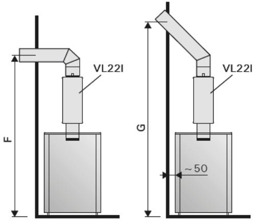
Рисунок 8. Присоединение каменки к каменному дымоходу (все размеры приведены в миллиметрах)
