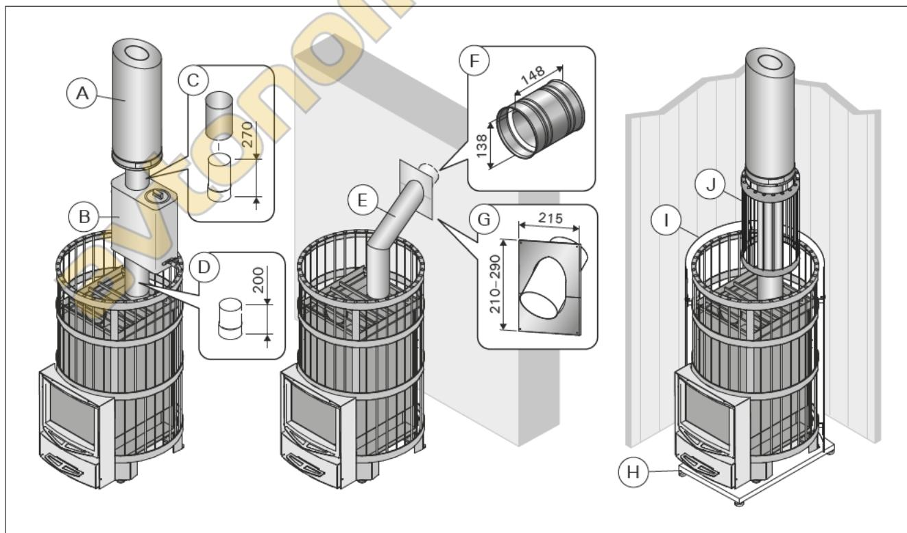
Рисунок 14. Дополнительные принадлежности (все размеры приведены в миллиметрах)
