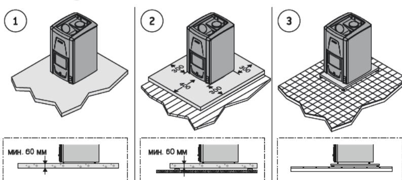
1. Бетонный пол без плитки. Каминку можно устанавливать на бетонный пол без каких-либо особых мер предосторожности, если толщина бетона составляет, по меньшей мере, 60 мм. Убедитесь, что в бетоне под каминкой нет электрических проводов или труб водопровода.
