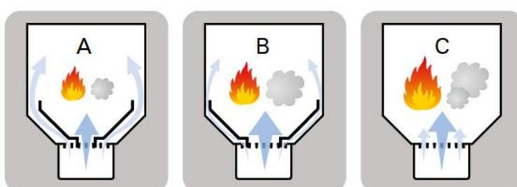
Все каменки оснащены специальным приспособлением, которое улучшает процесс горения: специальные каналы, подающие воздух в топку, проводят часть его над огнем в верхнюю часть топки. При этом печные газы также сгорают и вырабатывают тепло. Каменки серии Legend имеют аналогичную конструкцию колосниковой решетки (стр. 12–13).
