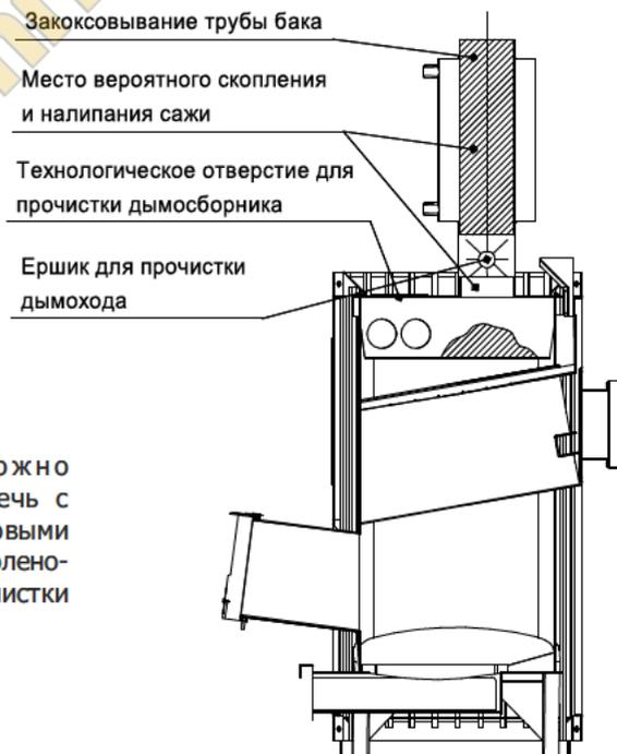
Для профилактики можно периодически проталкивать печь с пустым баком сухими осиновыми дровами. Можно применять «полентрубочист» (для химической очистки дымоходов).
