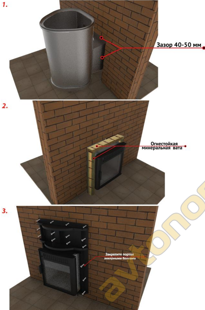
Рисунок 8.2. Схема установки печи
