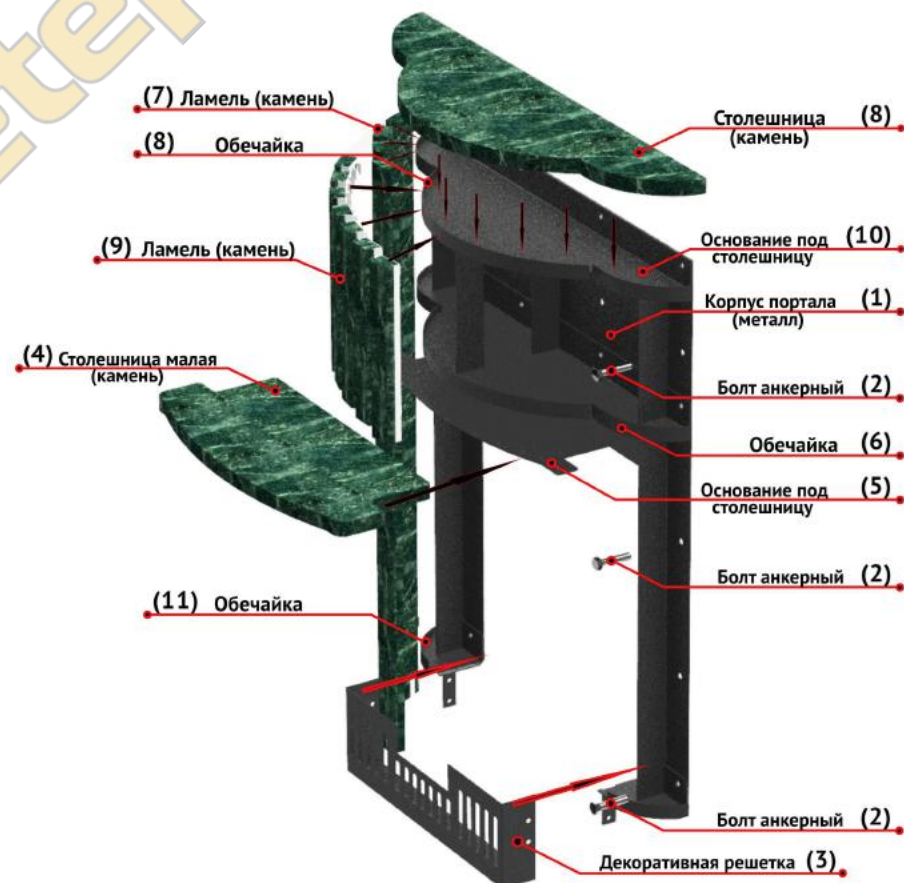
Рисунок 8.4. Схема установки и крепления портала печи.
