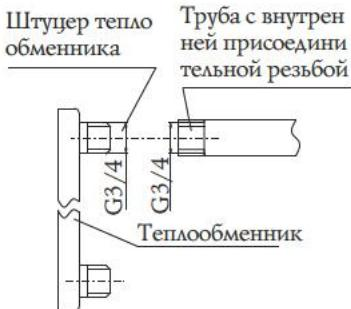
Рисунок 13. Присоединение трубопровода напрямую.
