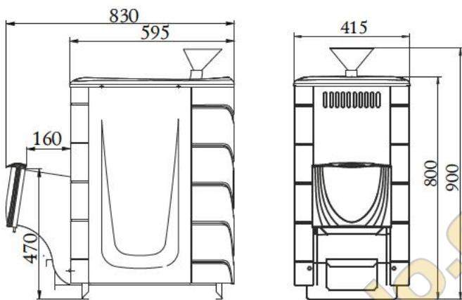
Рисунок 1. Габаритные размеры печи «Ангара 2012 Inox»
