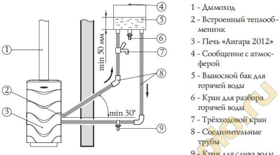
Рисунок 11. Схема монтажа системы водонагрева с использованием встроенного теплообменника
