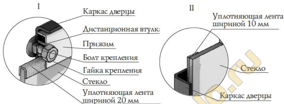
Рисунок 15. Крепление светорозрачного экрана дверцы модели «Витра»
