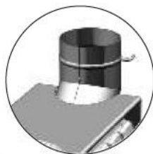
б) выход для дымовой трубы вверх
