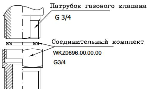
Газовую трубу подключи к потрубку газового узла аппарата с помощью соединительного комплекта № WKZ0696.00.00.00. как на рис. 3.4.1.
