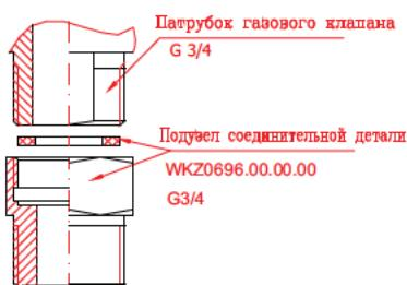
Газовую трубу подключить к патрубку газового клапана котла при помощи подузла соединительной детали № черт. WKZ0696.00.00.00. Как на рис. 3.4.1.
