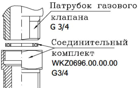
Рис. 3.4.1. Подключение соединительного комплекта
