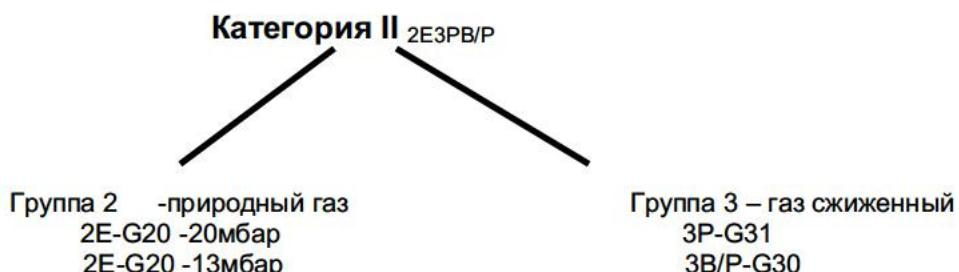
Перевод газового аппарата на другой вид газа, заключается в замене сопел горелки, приспособленных для сжигания данного вида газа, а также в регулировании минимального и максимального давления газа на модуляторе (рис.4.2.2.1.), а также регулировании давления газа для начальной и максимальной мощности аппарата на панели управления (смотри описание в п.4.2.3).
