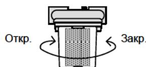
Не допускайте сильного засорения топливного фильтра. Регулярно чистите фильтр керосином или производите замену.
