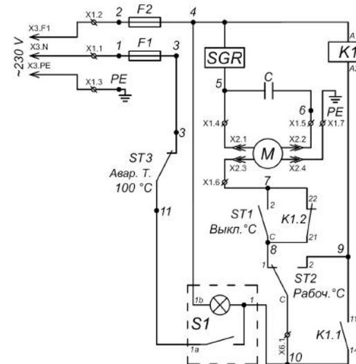
Рис. 1е Электрическая принципиальная схема котла
