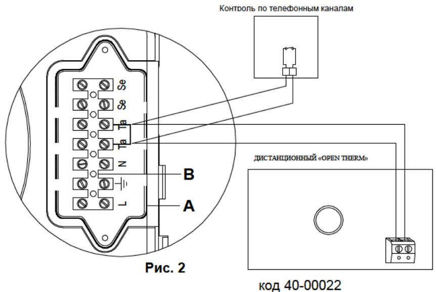
После подсоединения проводов установите на место пластину «А», а затем переднюю панель корпуса.
