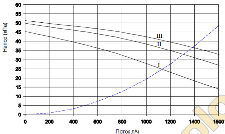
III — Напор насоса при максимальной скорости
