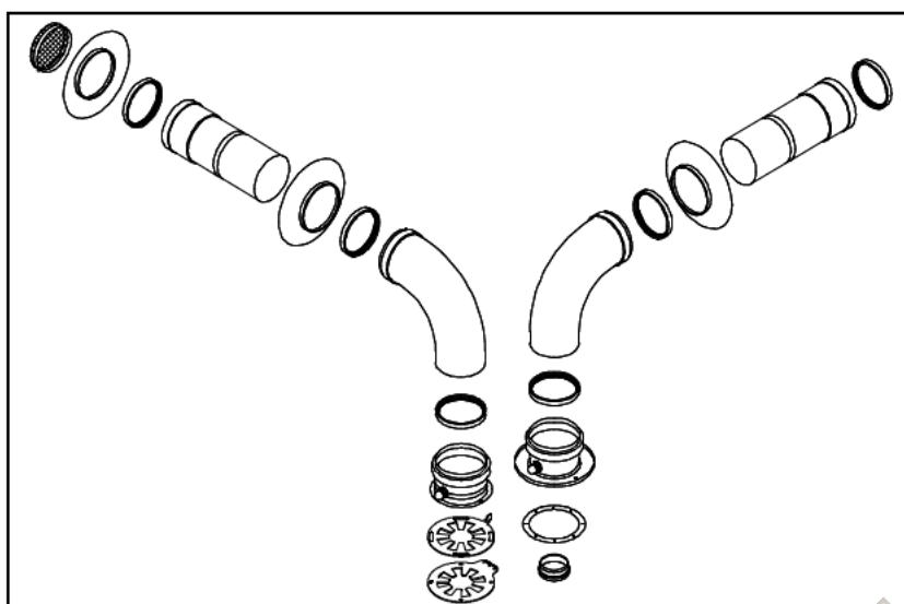
*Отводит отработанные газы и производит забор воздуха для горения через два отдельных канала диам. 80 мм.*
