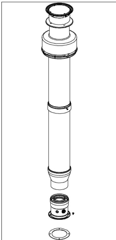
*Отводит отработанные газы и производит забор воздуха для горения на уровне крыши через два концентрических канала. Внешний канал диам. 125 мм производит забор воздуха для горения, а внутренний канал диам. 80 мм отводит отработанные газы.*
