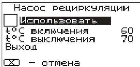
Для исключения конденсации продуктов сгорания на стенках теплообменника рециркуляционная система должна поддерживать температуру теплоносителя на входе в котел выше 65°C.
