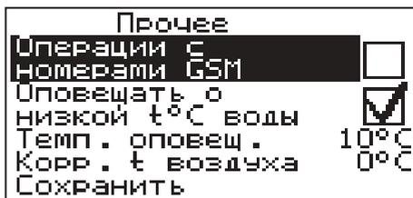
Для включения оповещения о снижении температуры теплоносителя ниже определенного уровня установите галочку в строке “Оповещать о низкой t°С воды”. Температура устанавливается в пункте “Темп.оповещения” данного меню. После регистрации модуля в сети мобильного оператора появляется индикатор работы модуля-GSM (12) на передней панели пульта управления.
