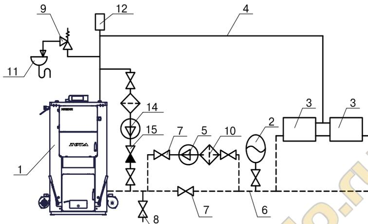
**Рис.7 Схема закрытой системы отопления
