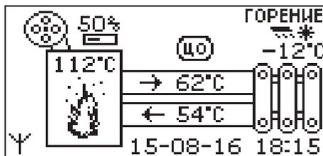
7.3.6. В режиме розжига или режиме автоматического горения можно временно остановить вентилятор для загрузки топлива. Для этого нужно нажать кнопку “Отмена” (3) Рис.2 на пульте управления. Вентилятор остановится и на экране появятся сообщение с предложением загрузить топливо.
