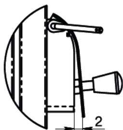
Как только температура воды в котле начнет подниматься, регулировочная заслонка будет закрываться. Таким образом регулируется температура воды на выходе из котла.
