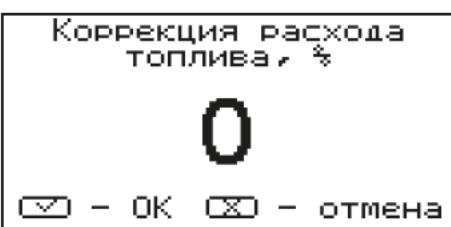
Пункт меню предназначен для коррекции времени подачи топлива относительно заводских настроек. Параметр используется для точной настройки количества топлива подаваемого в горелку с целью получения оптимального соотношения топливо/воздух.
