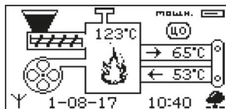
При достижении температуры уходящих газов, соответствующей устойчивому горению, котел переключится в режим автоматического горения и на дисплее отображается основной экран котла.
