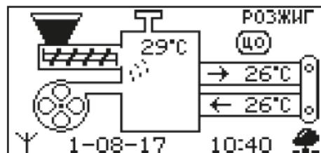
7.3.4. При розжиге котла для работы в режиме автоматического горения появится экран, который предлагает запустить котел вручную или автоматически.
