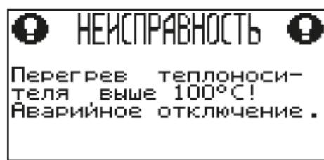
Если температура теплоносителя поднимается выше 100°C, срабатывает аварийный невозвратный термовыключатель (поз.9) Рис.5, отключится привод шнека, вентилятор и включится аварийный звуковой сигнал. Для повторного включения котла необходимо устранить причину превышения температуры теплоносителя и затем нажать на кнопку возврата аварийного термовыключателя (9) до щелчка.
