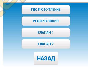
7.5.9. В меню "Насосы и клапаны" настраиваются режимы работы насосов, которыми может управлять котел и режимы термосмесительных клапанов.
