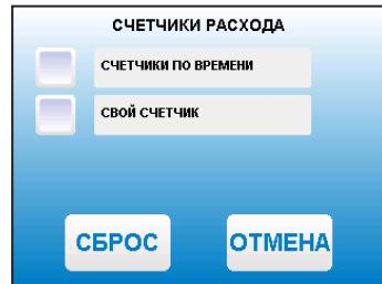
Для сброса следует установить галочку напротив нужного пункта и нажать кнопку “СБРОС”. Общий счетчик за все время эксплуатации при этом не сбрасывается.
