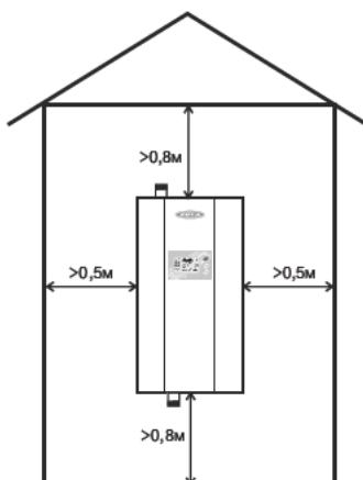
**Рис.4 Схема установки электроводонагревателя**
