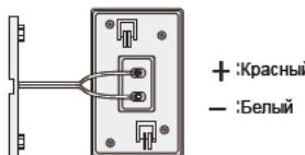
4) Кабель комнатного термостата должен быть установлен отдельно на видном месте.
