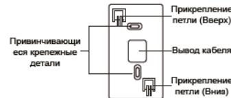
3) Прикрепите термометр (CTR-6070), прижав их к стене таким образом, чтобы подвесная часть совпадала с крепежной петлей, и потяните его вниз.
