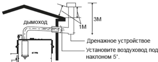
Установите воздуховод на 3м выше котла и "Т" блок в конце, чтобы предотвратить неполное сгорание, вызванное встречным ветром.
