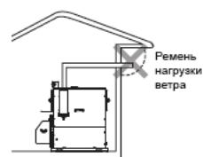
Если Вы установите воздуховод в **ремне** нагрузки ветра, может произойти неполное сгорание, что приведет к образованию сажи, сокращению эффективности, проблемам с безопасностью и т.д. В этом случае, котел не может эксплуатироваться в полной мере; следовательно, необходимо установить воздуховод за пределами ремня нагрузки ветра.
