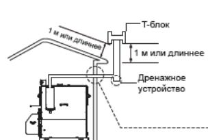
Установите воздуховод таким образом, чтобы его верх находился вне зоны ремня нагрузки ветра с тем, чтобы ветер не оказывал воздействие на воздуховод.
