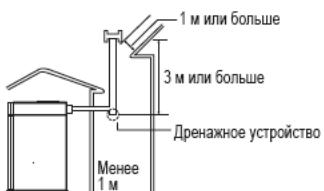
Если на расстоянии 1 м от жаровой трубы есть здание или какое-либо препятствие, труба устанавливается на 1 м выше крыши здания.
