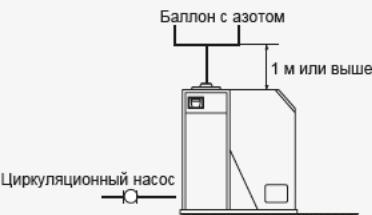
Не используйте предохранительный клапан на трубопроводе добавочной воды и на сливной линии.
