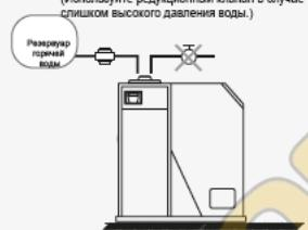
Используйте циркуляционный насос с соответствующей спецификацией и установите выпускной клапан.
