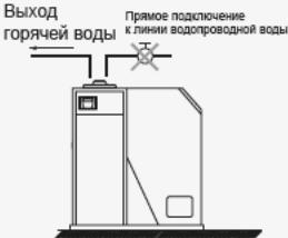
Давление в трубопроводе горячей воды для хозяйственных нужд должно быть в диапазоне 0,6 – 1 кг/см<sup>2</sup>. При использовании насоса подачи воды или прямом соединении с линией водопроводной воды установите редукционный клапан.
