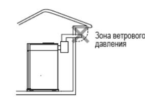
Если жаровая труба устанавливается в зоне с ветровым давлением, это может привести к чрезмерному образованию сажи в результате неполного горения топлива, что снижает эффективность агрегата; может быть запущено аварийное отключение, что вызовет нестандартную работу котла. С целью предотвращения этой проблемы жаровая труба должна устанавливаться в месте за пределами зоны ветряного давления.
