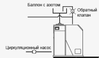
Используйте тройник на нагревающейся выходе трубы отопления и сливной трубы, чтобы установить расширительную трубу на отведенной трубе. (Установите трубу предотвращения естественной циркуляции при установке в подвале.)
