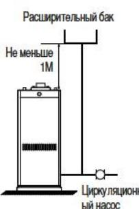
Установите расширительный бак на высоте более 1 м от верхней части отопительного котла. (в подземном помещении устанавливайте на высоте более 1м от высоты прокладки труб на полу помещения)
