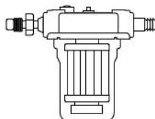
Необходимо производить замену топливного фильтра отопительного котла более 1–2 раз в год, так же как и производится замена один раз в три месяца топливного фильтра автомобиля
