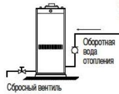
Пользуйтесь циркуляционным насосом соответствующей мощности, установите сбросной вентиль
