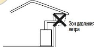
Установка в зоне давления ветра становится причиной неполного сгорания, образования сажи, снижения коэффициента полезного действия, предохранительного отключения. Т.к. в этих случаях отопительный котел не может работать в нормальном режиме, рекомендуется устанавливать дымовую трубу вне зоны давления ветра.
