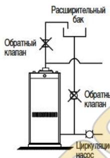
Запрещается использование Обратного клапана на выпускной трубе и трубе дополнительной подачи воды
