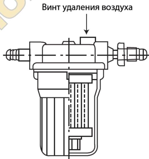
Рисунок 2 Топливный фильтр
