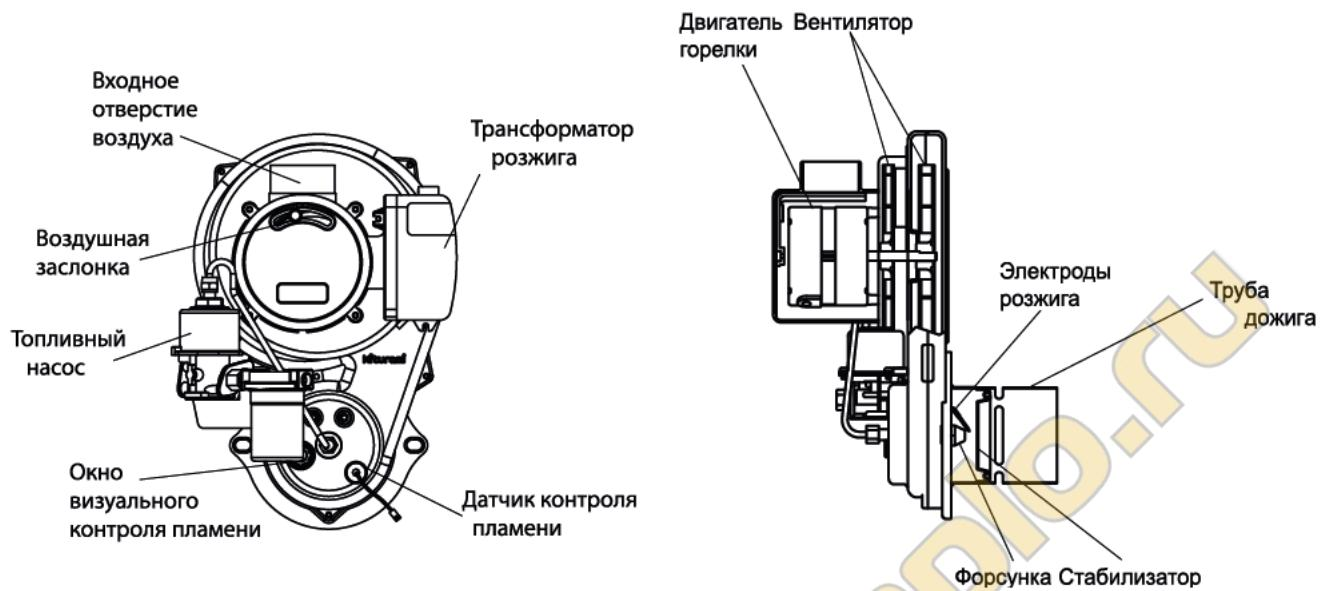
Рисунок 3. Устройство и назначение основных частей для горелок STSO-13/21
