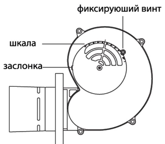
Расположение органов регулировки в зависимости от конструкции горелки
