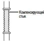
При прокладке труб отопления, если прямые участки труб слишком длинные, возникает явление растяжимости труб, вызываемое температурой обратной воды или могут образоваться трещины на сварочных швах. При удлинении прямых участков труб рекомендуется изогнуть средние участки труб колено или установить компенсирующий стык, который примет на себя действие растяжимости.
