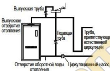
Запрещается устанавливать какие-либо вентили на подающей трубе и выпускной трубе отопительного котла.
