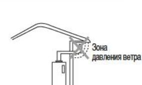
Если установить в зоне давления ветра, это может привести к образованию сажи из-за неполного горения, снижению коэффициента полезного действия, аварийным остановкам. Рекомендуется установить дымовую трубу вне зоны давления ветра, т.к. в ином случае невозможна нормальная работа отопительного котла.
