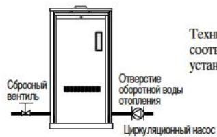
Технические характеристики циркуляционного насоса должны соответствовать объему обратной воды отопления. Рекомендуется установить сбросной вентиль.
