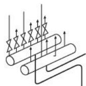
Нельзя устанавливать какие-либо вентили на трубе обратной воды и отопительной трубе горячей воды. Если Вы устанавливаете вентиль, следует установить распределитель и затем вентиль таким образом, чтобы можно было по необходимости им пользоваться. Будьте осторожны, если все вентили закрыты, возможны случаи деформации, вызванные избыточным давлением теплообменника или действием предохранительного клапана из-за избыточного давления в отопительном котле.
