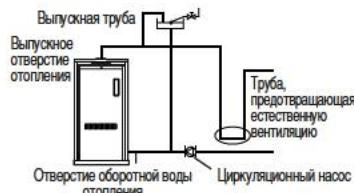
Для предотвращения естественной циркуляции, вызываемой конвекционным действием, при прокладке отопительных труб горячей воды рекомендуется установить трубу, предотвращающую естественную циркуляцию. При прокладке труб отопления используйте предохранительное выпускное отверстие и выпускное отверстие отопления, которые позволят предотвратить разрушение отопительного котла вследствие расширительного давления.
