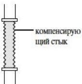
При прокладке труб отопления, если прямые участки труб слишком длинные, возникает явление растяжимости труб, вызываемое температурой обратной воды или могут образоваться трещины на сварочных швах. При удлинении прямых участков труб рекомендуется изогнуть средние участки труб колено или установить компенсирующий стык, который примет на себя действие растяжимости.
