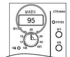
7 Если после установки температуры загорается лампочка «Управление/контроль», отопительный котел работает в нормальном режиме.
