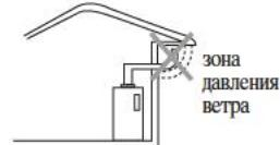
Если установить в зоне давления ветра, это может привести к образованию сажи из-за неполного горения, снижению коэффициента полезного действия, аварийным остановкам. Рекомендуется установить дымовую трубу вне зоны давления ветра, т.к. в ином случае невозможна нормальная работа отопительного котла.
