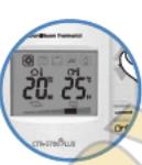
8. Если после установки желаемой температуры в помещении загорается лампочка-индикатор включения, значит, котел работает в нормальном режиме.
