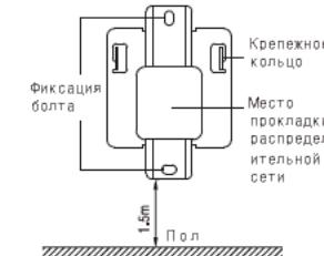
► Подсоедините распределительную сеть к клеммам задней части комнатного термостата-регулятора (CTR-5550 or 5700).
