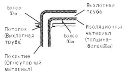
► При удлинении дымовой трубы следует устанавливать ее таким образом, чтобы избежать свисания
