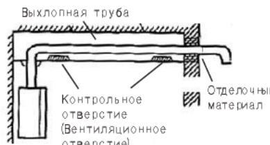
► Во избежание утечек полных газов соединительные участки должны быть прочно скреплены и покрыты огнеупорным материалом, за исключением металла, а также жаростойким кремнем.
