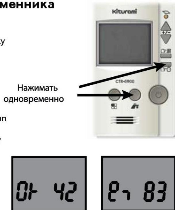
Рисунок 16. Настройка типа теплообменника
