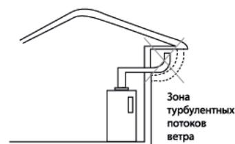
Если в пределах 1 м от дымовой трубы находится высокое здание рекомендуем устанавливать трубу выше 1 м от крыши высокого здания
