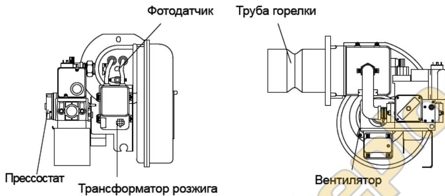
Рисунок 5. Устройство и назначение основных частей горелок TGB-50/70
