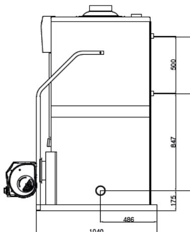
Рисунок 20. Габаритные и присоединительные размеры котлов KSG-150
