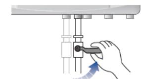
3. Снимите фиксирующий зажим а затем извлеките фильтр из устройства.
