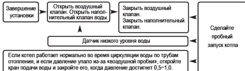
Закройте наполнительный клапан при запуске котла. Если наполнительный клапан открыт при запуске котла, могут возникнуть следующие неисправности.
