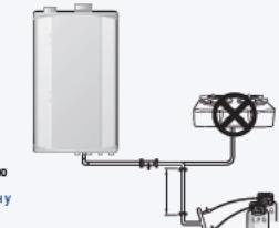
\* Установить бытовой регулятор давления в соответствии с указанной нормой расхода сжиженного нефтяного газа.
