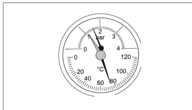
Рис. 13 Термоманометр
