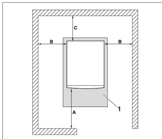
Рис. 6 Расстояния от стен в помещении установки оборудования
