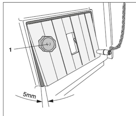
Рис. 8 Крепление цепи к воздушной заслонке
