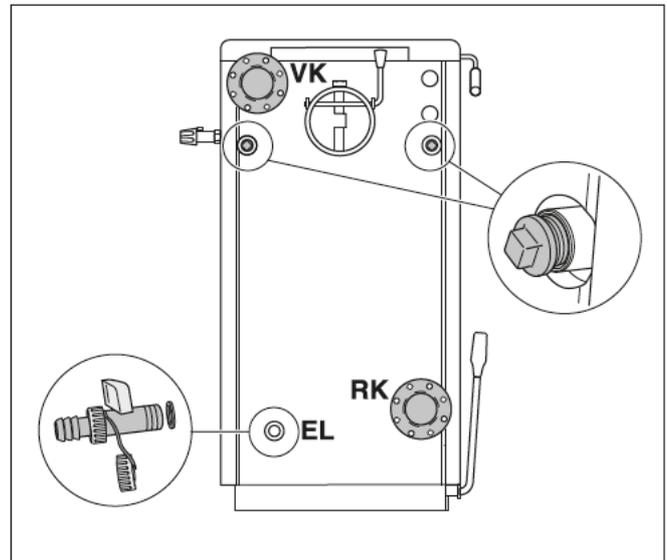
Рис. 11 Гидравлические подключения
